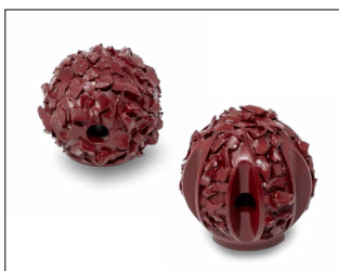
Hartmetall-Kugelfräser Einsatzgebiet: Öffnen von Hausanschlüssen und Einläufen
