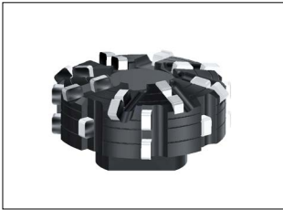
Diamant Einlaufräser - mit Spannuten + Spülbohrungen - Einsatzgebiet: Öffnen von Hausanschlüssen und Einläufen Entfernen von einragenden Stützen und Ablagerungen
