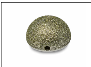
Diamant Halbkugelfräser Einsatzgebiet: Öffnen von Hausanschlüssen und Einläufen, feine Nachbearbeitung von Folienresten (UV)Liner
