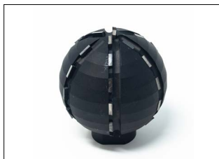
Diamant Kugelfräser - mit Spannuten + laufruher Schnitt - Einsatzgebiet: Öffnen von Hausanschlüssen und Einläufen
