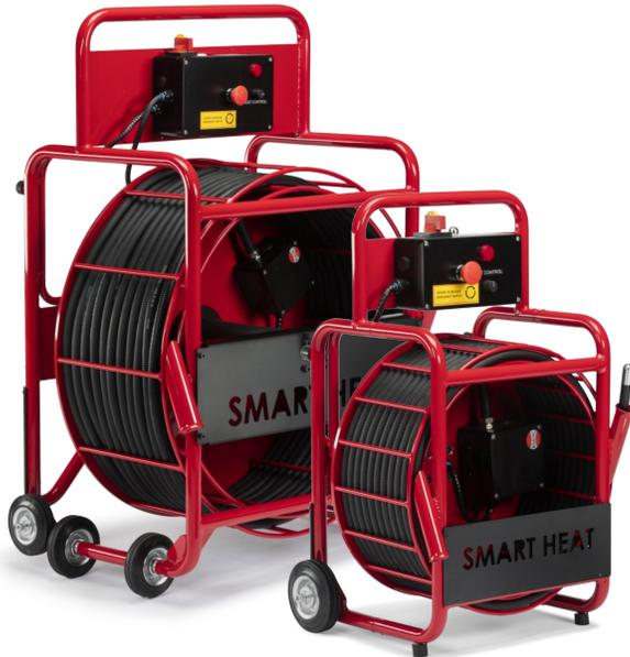
Inteligentní tepelné kabely Picote urychlují váš proces vytvrzování vložky až o 35% rychleji, což pomáhá zajistit dokončení podle plánu vytvrzování pryskyřice.
