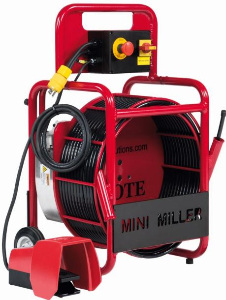
Mini Miller je vysokorychlostní jednotka s vysokým točivým momentem určená k čištění, odstraňování vodního kamene a odstraňování kořenů v potrubí DN50-100 a pro řezání v potrubí DN50-75. Ve spojení s Picote Mini Coating Pump je také schopen udělat vnitří nátěr epoxidem v potrubí DN50-150.
