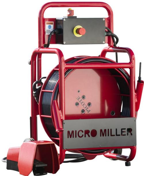
Micro Miller je určen k čištění, odstraňování vodního kamene a odstraňování kořenů v potrubích mezi DN50-100 a pro řezání / obnovení v potrubí DN50-75.
